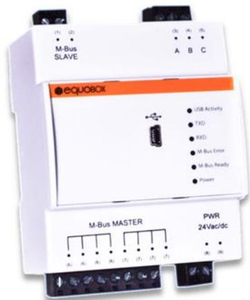
Il ripetitore e level converter M-Bus Y0583 permette l'interfacciamento con un rete di dispositivi compatibili con lo standard M-Bus (EN 13757-2 Physical Layer) e supporta fino a un massimo di 60 slave.
